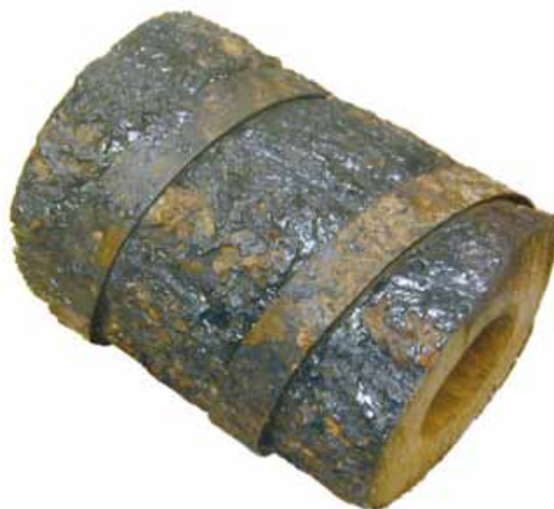
Conductă de lemn cu cercuri de fier
